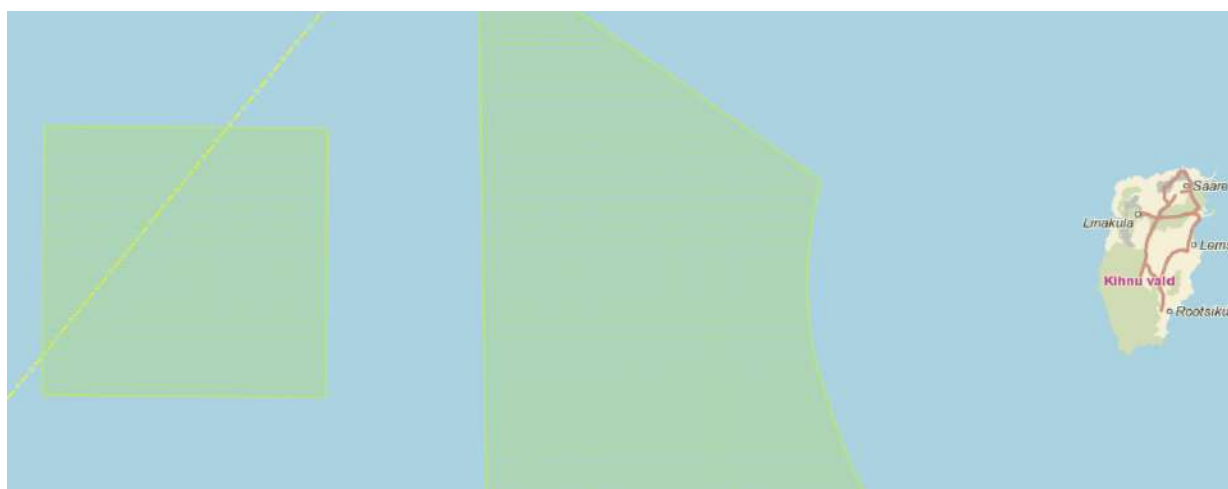
Joonis 11. Liivi lahe meretuulepark, Tuuletraal OÜ ruudukujuline arendusala 91 km 2 Kihnust 27 km läänes 380 MW.
